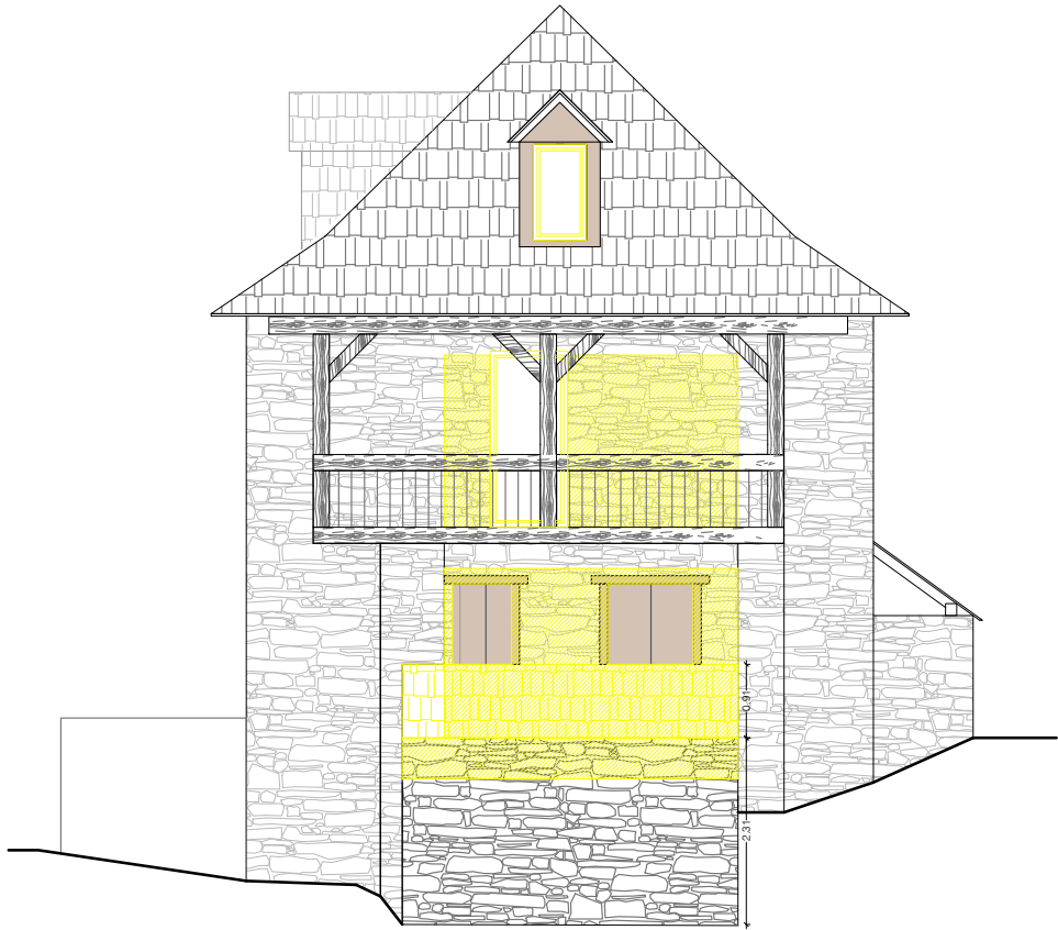
DERRIBO FACHADA SUR
